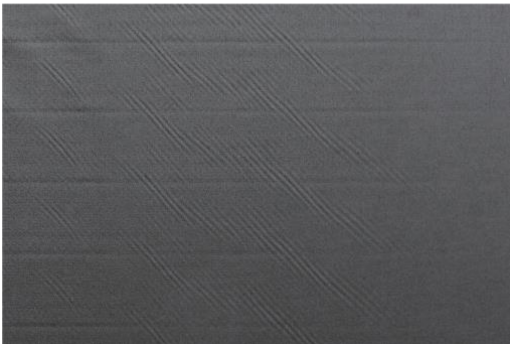
Afb. 9.4.4 Dwarsafdrukken door aansluiting aan de oprolas en zich aftekenende dwarsnaden kunnen in het doek zichtbaar zijn zie punt 4.2.7.
